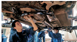
車検整備 車検の基準に合格するように、自動車の下回り(エンジンの一番下の部分)を点検します。
